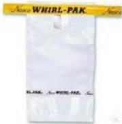
Whirl-Pak Homogenisierungsbeutel, Probebeutel, PE, steril, mit Schriftfeld
