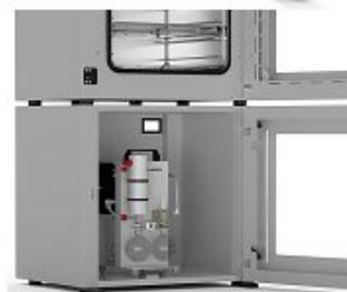
Der Solid.Line-**Klimaschrank** KBF-S ist die maßgeschneiderte Lösung für Langzeittests und beschleunigte Stabilitätstests von pharmazeutischen Produkten nach der ICH-Richtlinie Q1A. Der korrosions- und kondensatfreie Innenraum bietet auch bei voller Beladung extrem homogene Temperatur- und Feuchtebedingungen.
